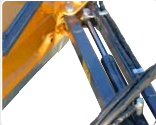
Martinetto per lo spostamento idraulico, interno ai bracci del parallelogramma. Side shift cylinder located inside the parallel arms.
