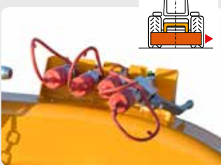
Rubinetto per il blocco idraulico in trasporto, inserimento manuale (no catene, no staffe). Hydraulic lock tap for transport. Manual engagement (no chains, no brackets).
