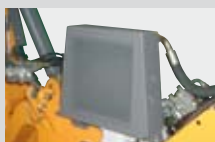
Scambiatore di calore con termostato (optional)
