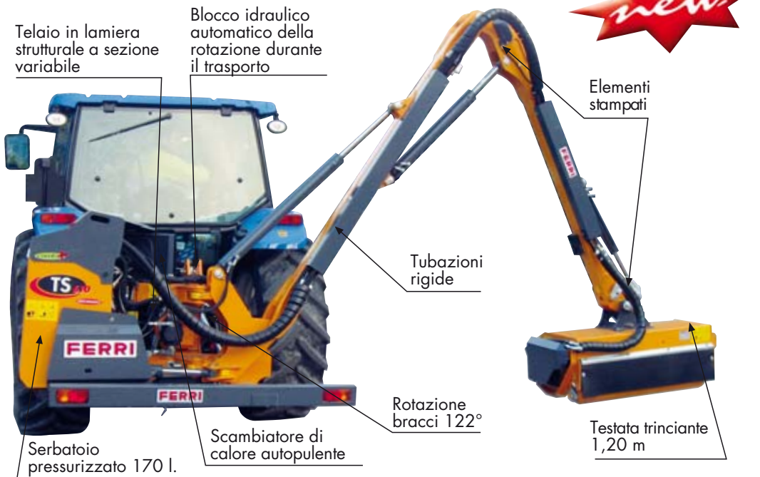
Comandi elettro-idraulici proporzionali Versione Comfort
