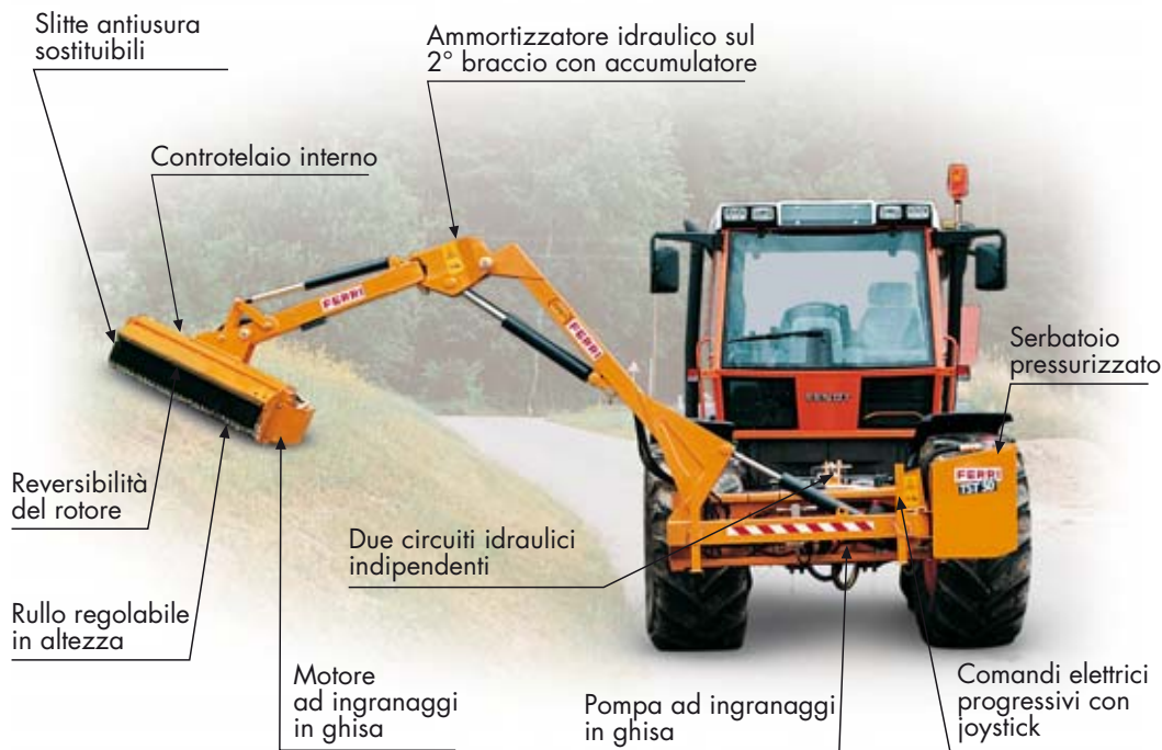
Rotore elicoidale "OVERLAP" a doppia elica con coltelli sovrapposti
