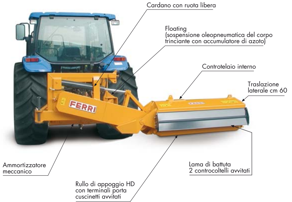
TLP160A versione anteriore per trattori con sollevatore e P.d.f. anteriore.
