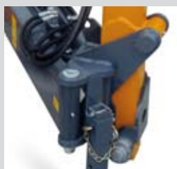
Telaio oscillante. Autolivellamento al terreno.
