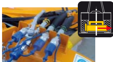
Rubinetto per il blocco idraulico in trasporto, inserimento manuale (no catene, no staffe).
