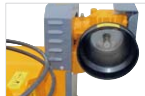
Gruppo moltiplicatore esterno alla trasmissione per una maggiore profondità di lavoro
