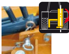
Perno per blocco meccanico in trasporto, (no catene, no staffe).
