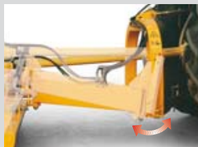
Telaio oscillante. Autolivellamento al terreno.
