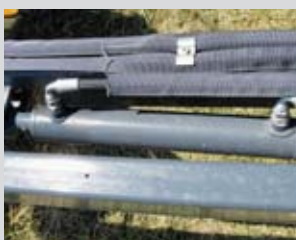
Martinetto per spostamento laterale posizionato internamente ai bracci del parallelogramma (posizione protetta in lavoro).
