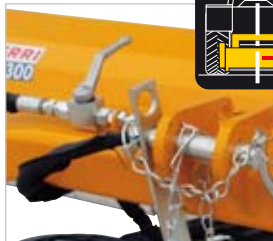
Rubinetto per il blocco idraulico in trasporto, inserimento manuale (no catene, no staffe).
