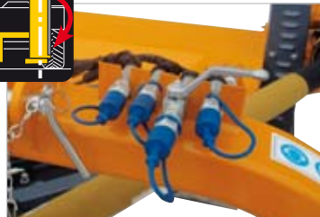
Rubinetto di blocco idraulico inclinazione del corpo trinciante in trasporto (no catene, no staffe).
