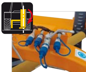
Rubinetto di blocco idraulico inclinazione del corpo trinciante in trasporto (no catene, no staffe).
