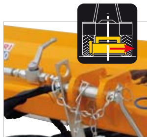
Rubinetto per il blocco idraulico in trasporto, inserimento manuale (no catene, no staffe).
