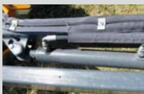
Martinetto per spostamento laterale posizionato internamente ai bracci del parallelogramma (posizione protetta in lavoro).
