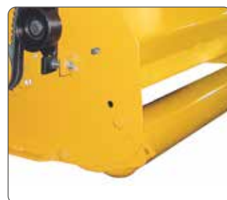
Rullo appoggio regolabile in altezza. Height adjustable rear roller.
